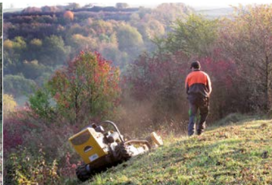
ferngesteuerter Mulcher für Pflege in Steilhanglage
